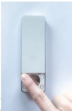
Appuyer sur le bouton ProgTx/SYNC à l'arrière de l'émetteur et maintenez-le enfoncé jusqu'à ce que le volet / store se déplace.
