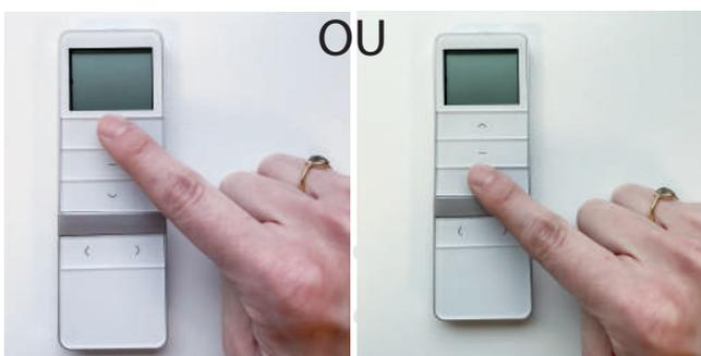
Dans les 5 secondes, appuyer sur le bouton MONTÉE, si le moteur tournait vers le haut OU sur le bouton DESCENTE, si le moteur tournait vers le bas.
