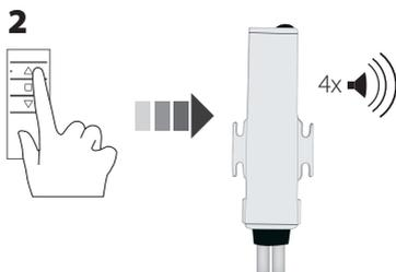
Maintenez la touche « montée » de la télécommande à appairer appuyée jusqu'à ce que le récepteur émette un bip ;
