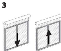
Manoeuvrez le moteur pour vérifier le sens de rotation. Si le sens de rotation est inversé, échangez les fils marron et noir de la connexion moteur.
