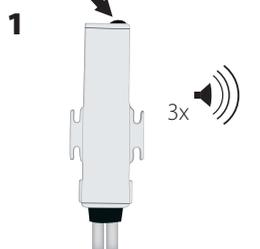
Avec un outil, appuyez sur le bouton d'appairage du récepteur (3), le récepteur émet trois bips pour confirmer le passage en mode réglage ;
